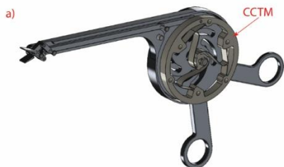
Hình 5.3 Mô hình kiểm phẫu thuật nội soi tích hợp CCTM: a) thiết kế và b) chế tạo
