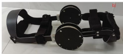
Hình 5.2 Thiết bị hỗ trợ chức năng khớp gối tích hợp CCTM: a) bản vẽ phân rã và b) thiết bị đã chế tạo
